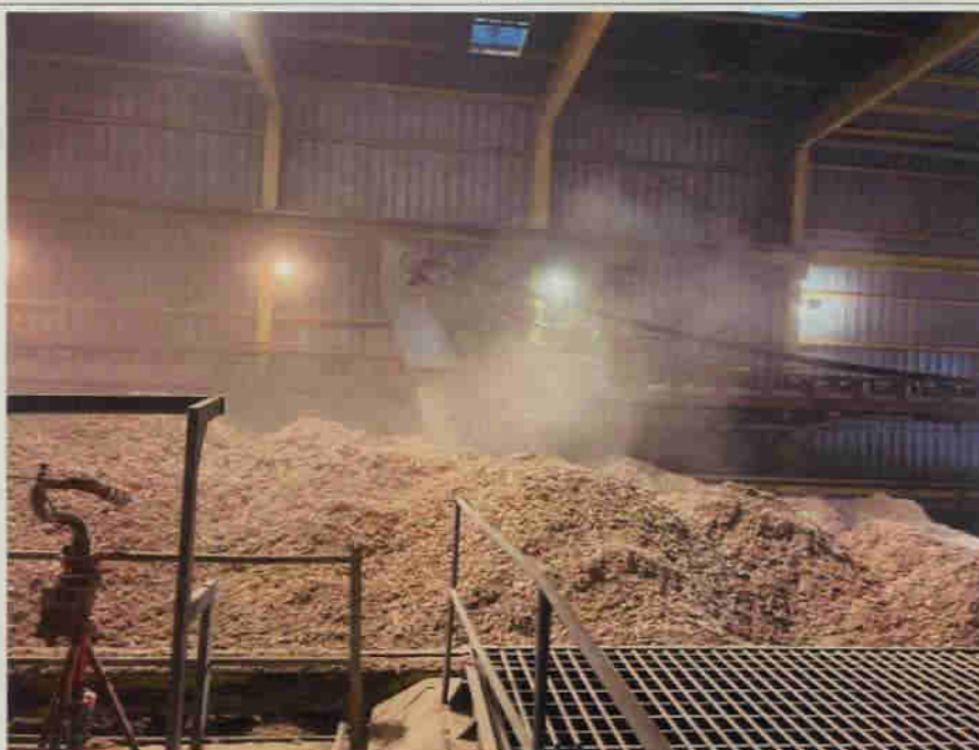
Hauteur de stockage constaté le 25/11/2022 (> à 8 mètres, trait de limitation non visible)
